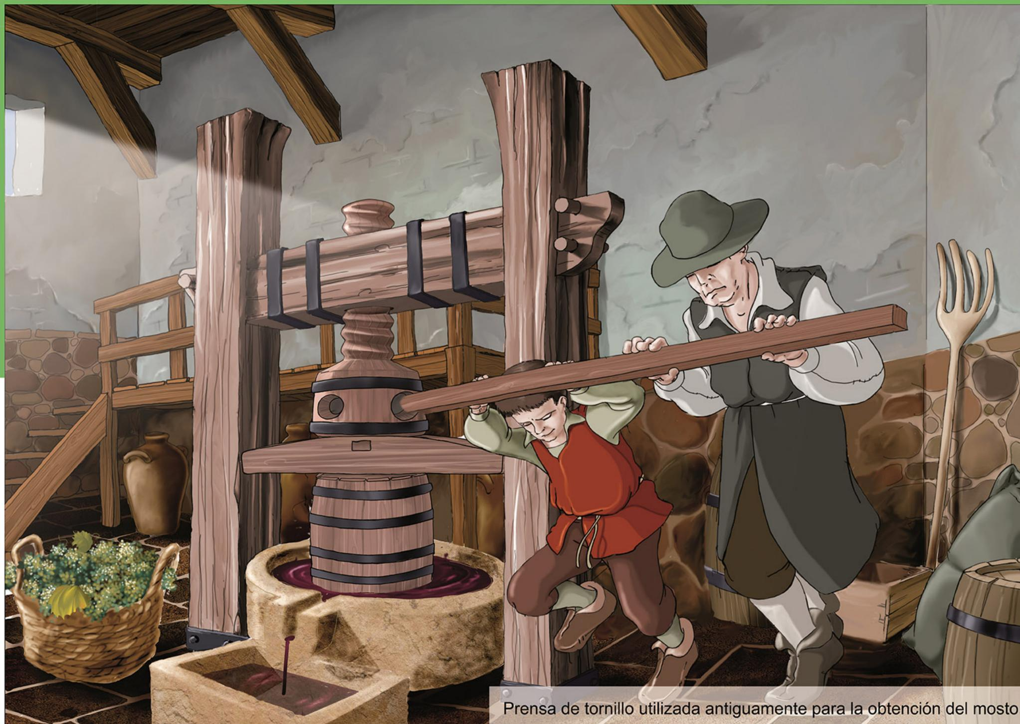
Prensa de tornillo utilizada antiguamente para la obtención del mosto.
